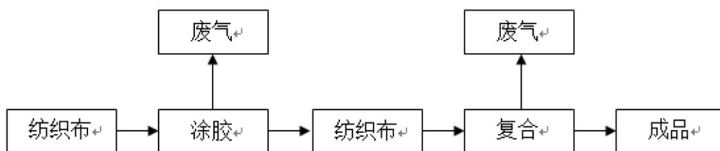
图1 复合布生产工艺流程及主要污染情况图
