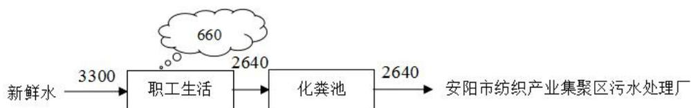
本项目水平衡示意图 (m<sup>3</sup>/a)
