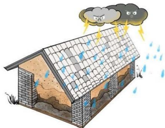
雨水冲刷侵蚀土墙
