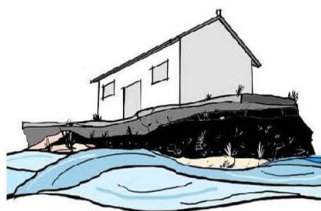
水流冲刷掏空地基
