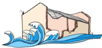
波浪作用击毁墙体
