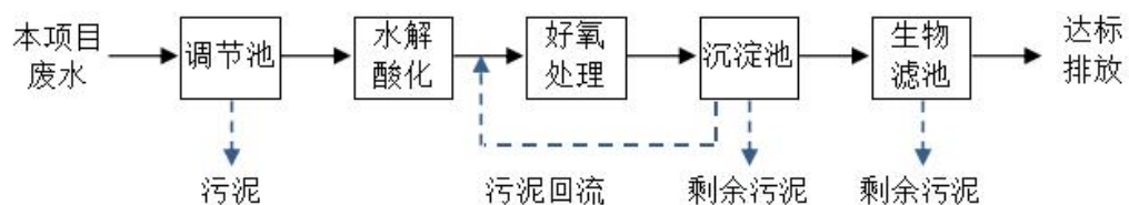
图4-1 厂区污水处理站工艺流程图
